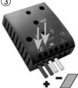
Conecte os fios condutores ao painel solar com a polaridade correcta. Para evitar qualquer voltagem nos fios, conecte primeiro o controlador e depois o painel solar. Observe o tamanho do fio recomendado:
