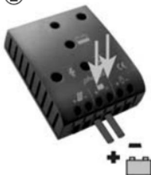
Conecte el cableado a la batería con la polaridad correcta. Para evitar voltaje en los cables, conecte primero el controlador y luego la batería. Tenga en cuenta la longitud de cable recomendada (mín. 30 a un máx. aprox. de 100 cm.) y el tamaño del cable:
