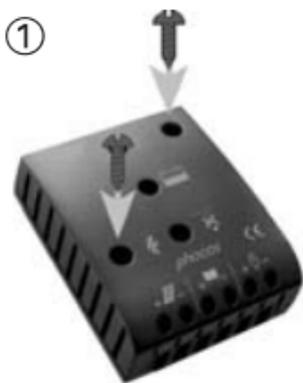
当使用螺丝安装控制器时，请确保使用的螺丝适合于固定物的材质。（选用直径4毫米的螺钉，螺钉头直径最大不超过8毫米，不要使用沉头螺丝）。
