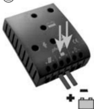
将控制器与蓄电池进行连接，注意极性。为避免线路上的电压，请将电线先连接在控制器上再连接到蓄电池上。
