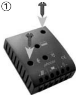
Quando a montar o controlador com parafusos, cuidado para que os parafusos sejam adequados ao material de fixação (utilize parafusos com 4 mm de haste e máx. 8 mm de diâmetro de cabeça, não escariados). Lembrar que os parafusos também devem suportar a força causada pela fiação. Certifique-se que as aberturas laterais do ventilador estejam desobstruídas.
