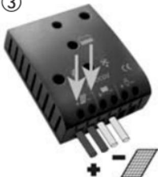
连接太阳能电池板，注意极性。为避免线路上的电压，请将电线先连接控制器，然后是太阳能电池板。推荐的线径如下：
