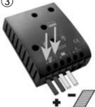
Connectez les câbles au générateur solaire avec la polarité adéquate. Afin d'éviter toute tension sur les câbles, connectez tout d'abord le contrôleur et après le générateur solaire. Respectez les recommandations pour
