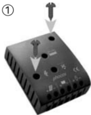
Lors du montage des vis sur le contrôleur, assurez-vous que vous utiliser les vis adéquates au système de fixation (utiliser des vis de 4 mm de longueur et ayant une tête de 8 mm de diamètre maximum, non fraisées). N'oubliez pas que les vis doivent aussi porter la force appliquée par le cablage.
