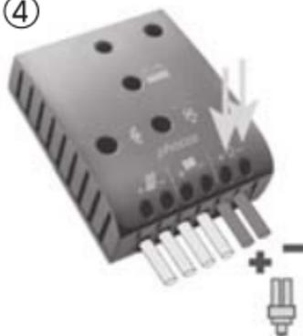
Connectez les câbles aux charges avec la polarité adéquate. Afin d'éviter toute tension sur les câbles, connectez tout d'abord le câble à la charge, et après le contrôleur. Respectez les recommandations pour la taille des câbles :
