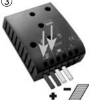
Conecte con la polaridad correcta los cables dirigidos al módulo solar. Para evitar voltaje en los cables, conecte primero el controlador y luego el módulo solar. Tenga en cuenta el tamaño de cable recomendado:
