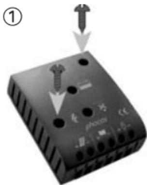
Befestigen Sie den Regler mit für den Untergrund geeigneten Schrauben (Schaft-Durchmesser 4 mm, Kopfdurchmesser max. 8mm, kein Senkkopf) an der vorgesehenen Stelle. Beachten Sie, dass die Schrauben auch die Kräfte der Anschlusskabel aufnehmen müssen.
