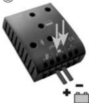
Schließen Sie die Zuleitungen zur Batterie polrichtig an. Um spannungsfrei zu arbeiten, schließen Sie die Kabel zuerst an den Regler, dann an die Batterie an. Achten Sie auf die Zuleitungslänge (mind 30 bis ca. 100 cm) und die Kabelquerschnitte:
