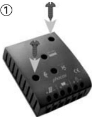
Para el montaje del controlador, asegúrese de utilizar tornillos adecuados al material de soporte (utilice tornillos de 4 mm de eje y un máximo de 8 mm. de diámetro). Tenga presente que los tornillos también han de soportar la fuerza aplicada por el cableado.
