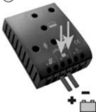
Connectez les câbles à la batterie avec la polarité adéquate. Afin d'éviter toute tension sur les câbles, connecter tout d'abord le contrôleur et après la batterie. N'oubliez pas que la longueur de câble recommandée est, (approximativement, de 30 cm minimum et de 100 cm maximum) et la taille du câble de :
