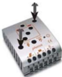
当使用螺丝安装控制器时，请确保使用的螺丝适合于固定物的材质。（选用直径4毫米的螺钉，螺钉头直径最大不超过8毫米，不要使用沉头螺丝）。
