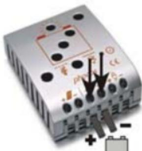
按照正确的极性，将蓄电池与控制器连接在一起。为避免故障，请先把电线接在控制器上，然后是蓄电池。
