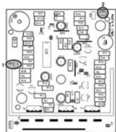
Para cambiar, ponga el puente ya sea en ambas clavijas de contacto o solo en una:
