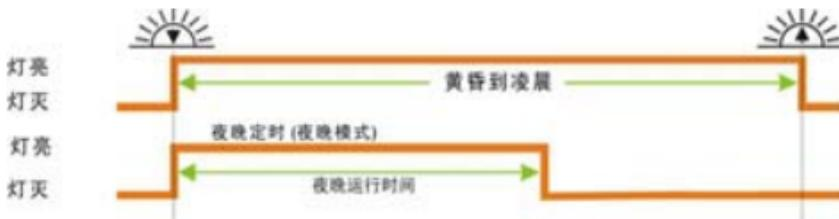
如果选择控制器工作在夜晚模式，在程序2中可以选择负载工作时间。控制器通过测量太阳能电池板的开路电压，识别现在是白天还是黑夜。在程序3中，允许使用者，根据所处地区的需要，和使用何种太阳能电池板，来自行设定光控点。
