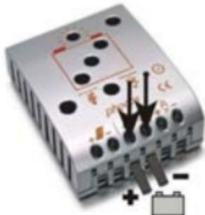
Conekte os fios condutores à bateria com a polaridade correcta. Para evitar qualquer voltagem nos fios, conecte primeiro o controlador e depois a bateria. Observe o comprimento recomendado do fio (mín. 30 cm a aprox. máx. 100cm) e o tamanho do fio:
