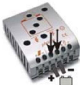
Schließen Sie die Zuleitungen zur Batterie polrichtig an. Um spannungsfrei zu arbeiten, schließen Sie die Kabel zuerst an den Regler, dann an die Batterie an. Achten Sie auf die Zuleitungslänge (mind. 30 bis max. 100 cm) und die Kabelquerschnitte:
