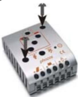
Monte o controlador na parede com parafusos apropriados ao material da parede. Use parafusos com máx. 4mm de haste e máx. 8mm de diâmetro de cabeça, não escariados. Cuidado para que os parafusos possam aguentar também a força aplicada pela fiação.
