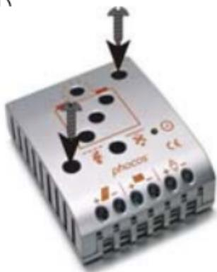
Befestigen Sie den Regler mit für den Untergrund geeigneten Schrauben (Schaft-Durchmesser 4mm, Kopfdurchmesser max. 8mm, kein Senkkopf) an der vorgesehenen Stelle. Beachten Sie, dass die Schrauben auch die Kräfte der Anschlusskabel aufnehmen müssen.
