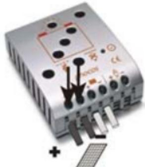
Raccordez les câbles allant vers le générateur solaire en respectant la polarité. Afin d'éviter toute tension sur les câbles, raccordez d'abord le contrôleur, puis le générateur solaire. Respectez les recommandations de taille pour les câbles :
