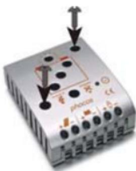
Fije el controlador a la pared con tornillos adecuados al material de la misma. Use tornillos de 4 mm. de eje como y 8mm. de diámetro. Tenga en cuenta que los tornillos deben soportar la fuerza aplicada en el cableado.
