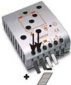
Schließen Sie die Zuleitungen zum Solargenerator polrichtig an. Um spannungsfrei zu arbeiten, schließen Sie die Kabel zuerst an den Regler, dann an den Solargenerator an. Achten Sie auf die Kabelquerschnitte:
