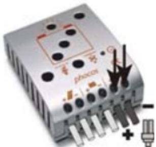
Conecte con la polaridad correcta los cables que van a los consumos. Para evitar voltaje en los cables, conecte primero el cable al consumo y luego al controlador. Utilice el grosor de cable recomendado:
