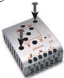
Fixez le contrôleur au mur avec des vis choisies en fonction du mur. Utilisez des vis non fraisées de 4 à 5mm max. et dont la tête a un diamètre de 8mm au maximum.
