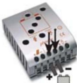
Conecte con la polaridad correcta los cables que van a la batería. Para evitar el voltaje de los cables, conecte el controlador primero y luego la batería. Aplique la longitud de cable recomendada (de 30 cm. como mínimo a 1 m. como máximo) y el grosor de cable recomendado:
