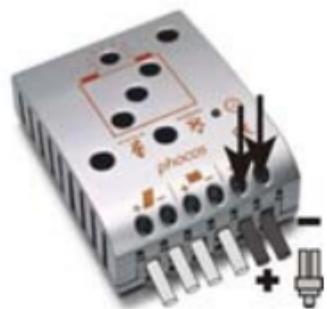
Conecte os fios condutores aos dispositivos com a polaridade correcta. Para evitar qualquer voltagem nos fios, conecte primeiro o fio à carga e depois ao controlador. Observe o tamanho do fio recomendado:
