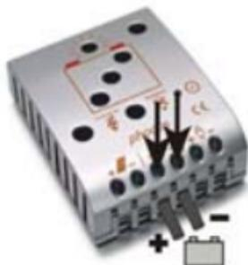
Connectez les câbles à la batterie avec la polarité adéquate. Afin d'éviter toute tension sur les câbles, connectez tout d'abord le contrôleur et après la batterie. Rappelez-vous que la longueur de câble recommandée est, (approximativement, de 30cm minimum et de 100cm maximum) et la taille du câble de :
